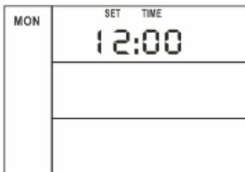
Die letzte Stelle der Uhrzeit blinkt. Geben Sie die Minuten ein und drücken Sie dann die Taste “MODE“. Die blinkende Anzeige wechselt auf die Zehnerstelle der Minuten. Stellen Sie diese Stelle ein und drücken Sie erneut die Taste “MODE“. Die blinkende Anzeige wechselt zur Einstellung der Stunden. Verfahren Sie für die Stunden und den Wochentag in der gleichen Weise.
