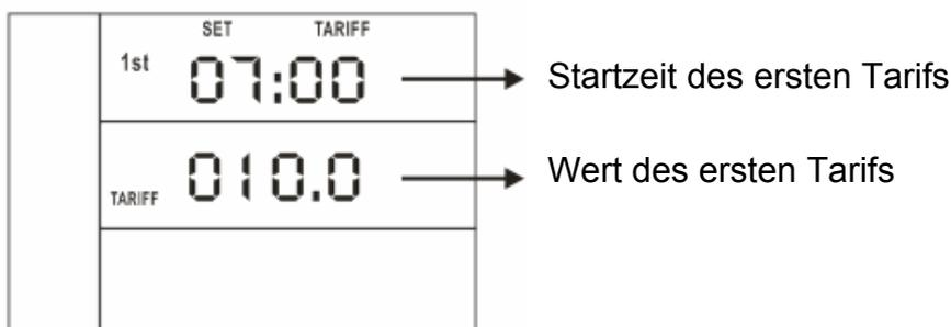
Die dritte Anzeigetafel dient zum Einstellen des zweiten Tarifs. Drücken Sie die Taste “**MODE**”, um die Einstellposition zu ändern. Drücken Sie die Taste “**▲**”, um den Wert von 0 bis 9 zu erhöhen. Drücken Sie die Taste “**▼**”, um den Wert von 9 bis 0 zu verringern. Startzeit und Wert sind zwei notwendige Faktoren, die eingestellt werden müssen.
